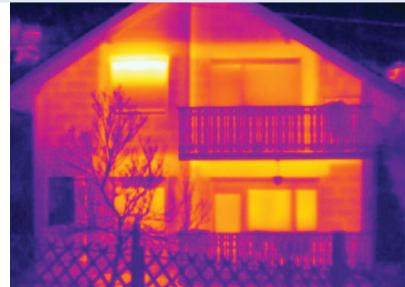
Ova porodična kuća izgrađena u periodu 1981–1990. s konstrukcijom spoljašnjih zidova od šupljih opekarskih blokova, s termoizolacionim slojem i obostrano malterisanim zidovima.
