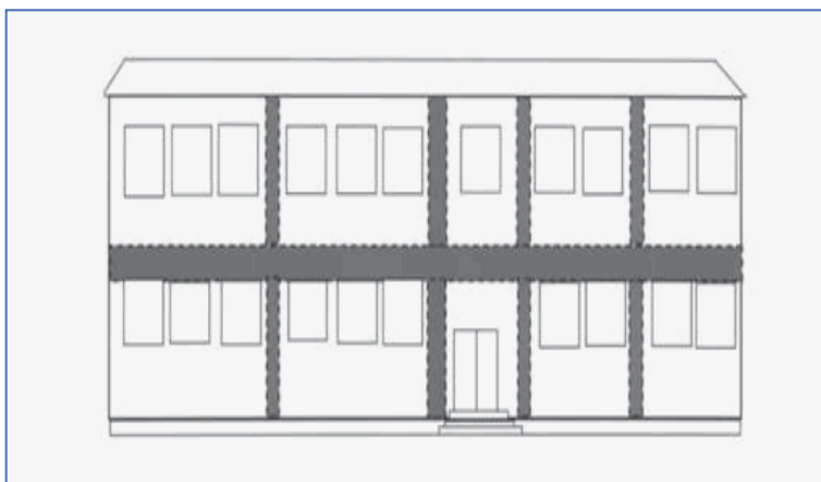
Слика 126 Хоризонталне и вертикалне противпожарне баријере
