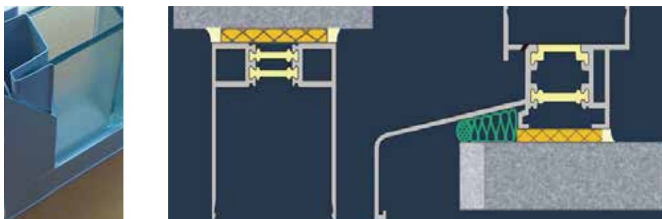
Слика 23 Детаљ постављања оквира код отвора са профилисаним стаклом
