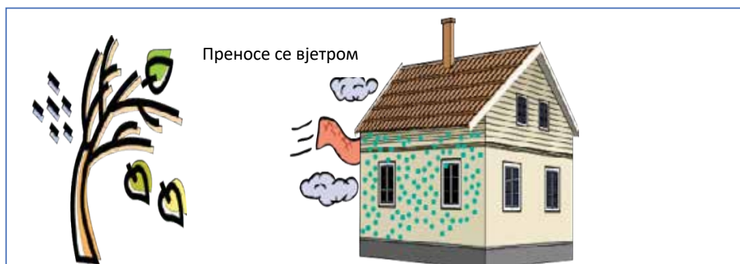
Слика 130 Механизми преношења алги и гљивица
