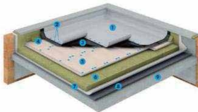
Слика 174 Раван кров – топлотна изолација од комбинације MW и XPS
