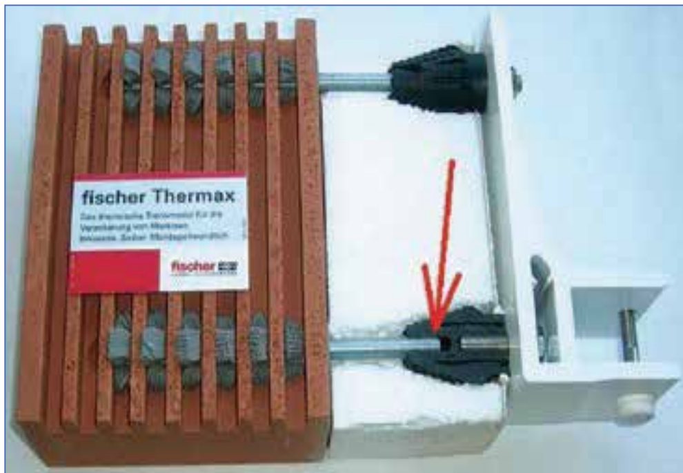
Слика 105 Детаљ вјешања вањских елемената примјеном вијчаног система са прекидом топлотног моста
