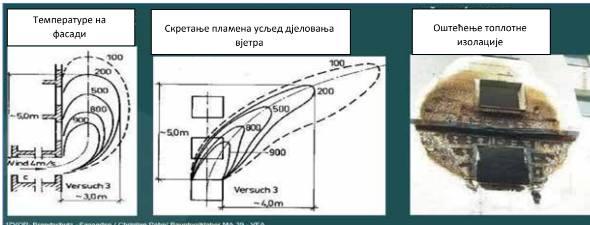
Слика 121 Развијање температуре у средишту пожара
