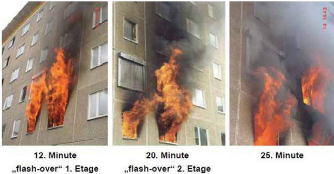
Слика 120 Брзина преноса пожара преко фасаде
