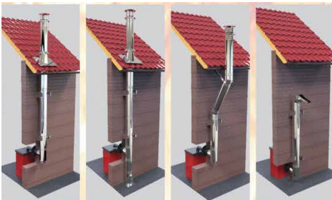
Слика 208 Примјери исправне монтаже димњака
