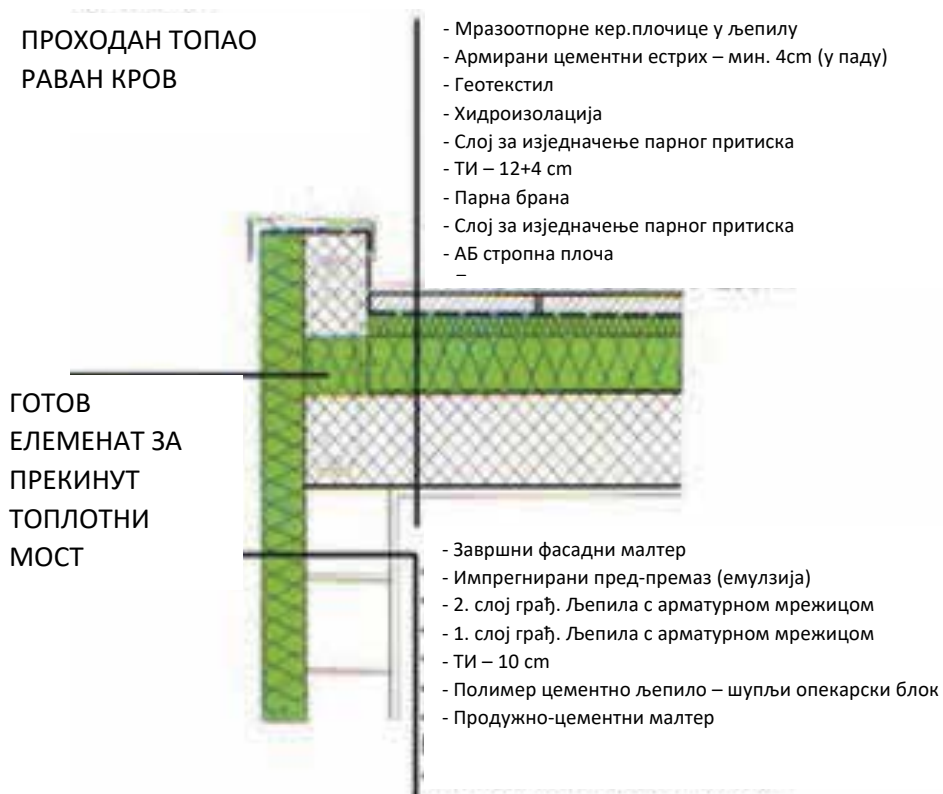
Слика 165 Слојеви проходног равног крова
