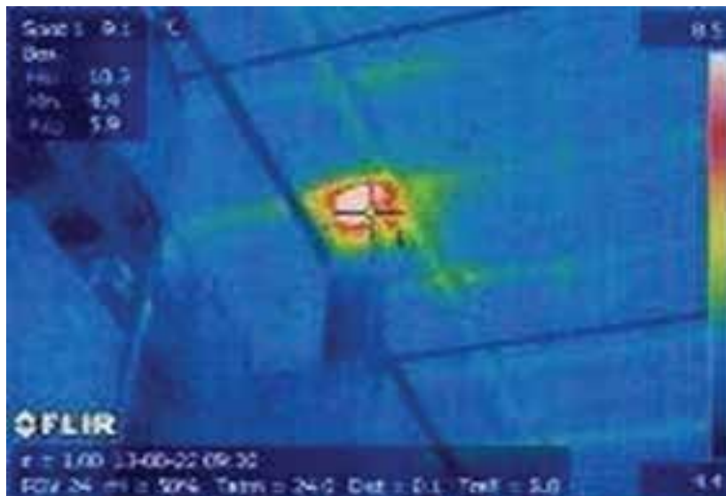
Слика 190 Конструктивни топлотни мостови
