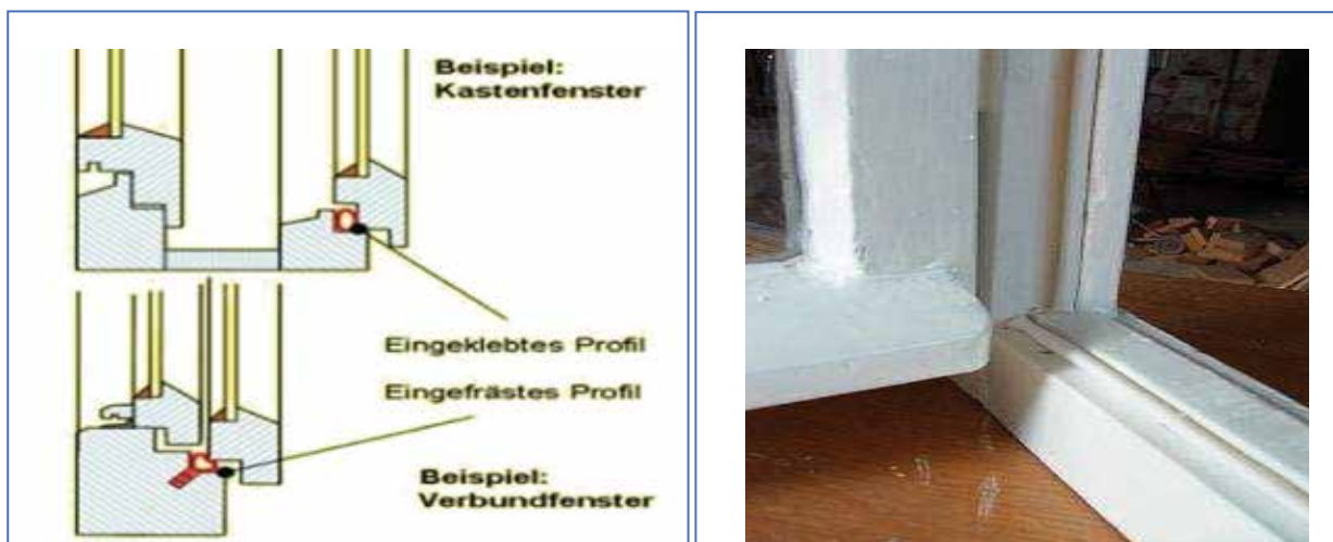
Слика 19 Накнадна уградња прозорских заптивки
